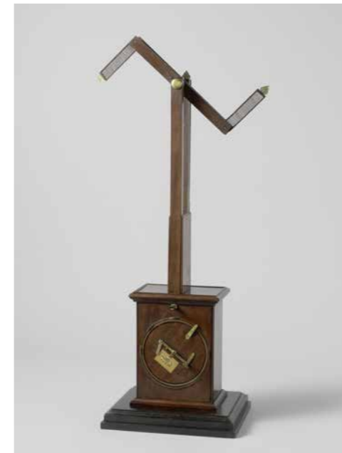
Semafoor, model van een optische telegraaf, 1792
